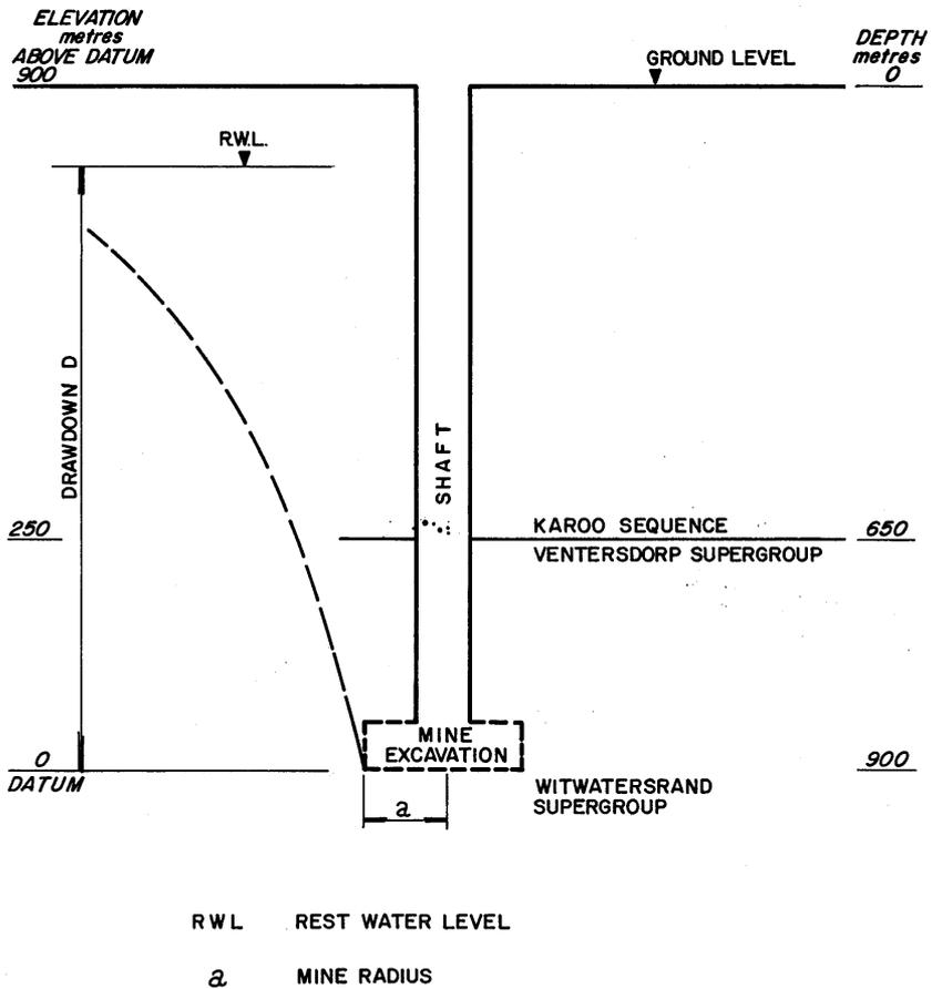
**FIG 1** AQUIFER AND MINE CONFIGURATION
